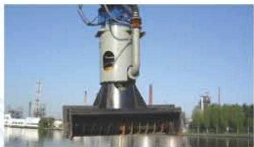
图7: 安装螺旋刀头的疏浚泵
