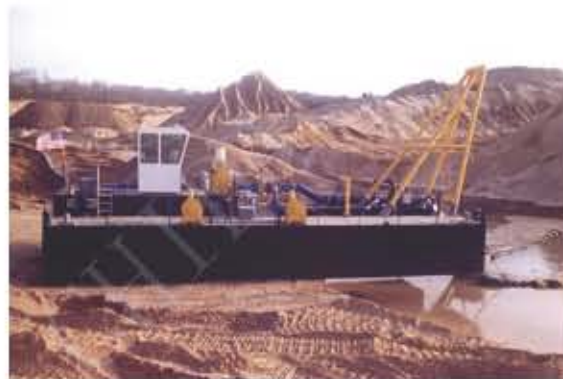
图 5：专用 DDP 挖泥船为采砂和矿石开采服务
