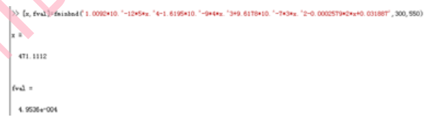
图 10 管口设置最佳距离计算过程图
