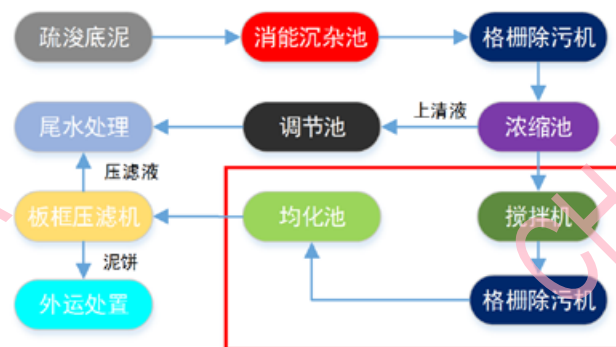
图10 搅拌机出口处加设格栅除污机
